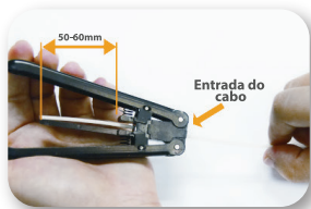
1- Desencape a camada externa do cabo
