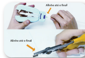
3- Desencape a camada de revestimento
